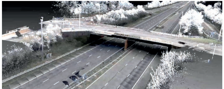
Pistepilvi sisältää paljon dataa – moottoritiestä kaapattu otos gigatavun kilometritä.
