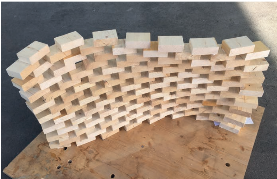
Fologramin ja RMIT-yliopiston työpajassa luotiin rakenne Hololens- ja AR-työkaluilla.
