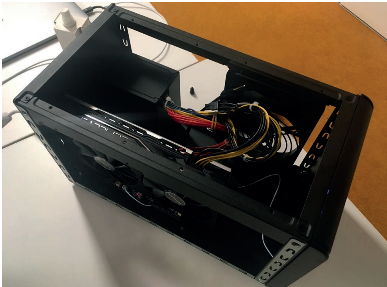
AMD RX 580 -mallinen näyttöohjain asennettuna Sonnet eGFX Breakway Boxiin. Näyttöohjain asentuu helposti sille varatuun paikkaan ja tämän jälkeen tarvitsee ainoastaan kytkeä lisävirtaliittimet ulkoisen kotelon virtalähteeltä näyttöohjaimen. Käytännössä näyttöohjaimen asentaminen ulkoiseen koteloon on tehty minuuteissa.
