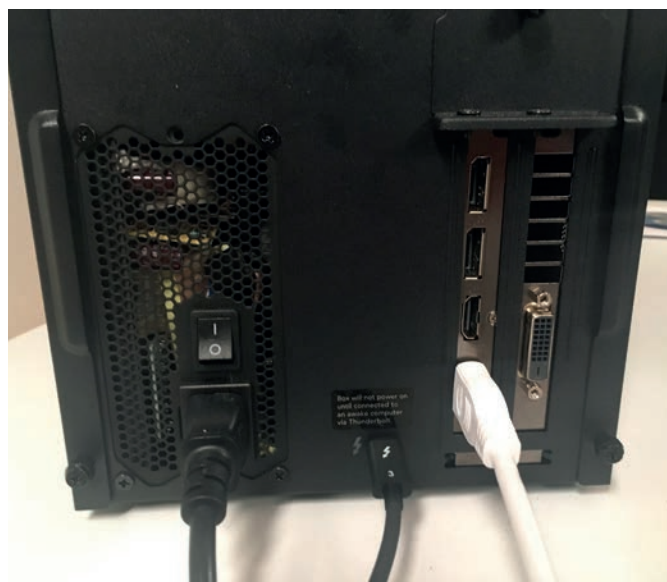
Sonnet eGFX Breakaway Boxin kaikki liitännät löytyvät kotelon takaosasta. Äärimmäisenä oikealla näkyy standardi virtajohto, jonka yläpuolella on virtalähteen virtakytkin. Seuraavana oikealla näkyy Thunderbolt-liitäntä, jolla kotelo kytketään tietokoneen Thunderbolt-liitäntään kiinni. Äärimmäisenä oikealla on näkyvissä näyttöohjaimen omat liitännät, joihin voidaan kytkeä ulkoisia näyttöjä. Sonnetin kotelo käynnistyy automaattisesti, kun se yhdistetään Thunderbolt-liitännän kautta tietokoneeseen ja vastaavasti kotelo myös siirtyy virransäästötilaan, kun se irroitetaan tietokoneesta.
